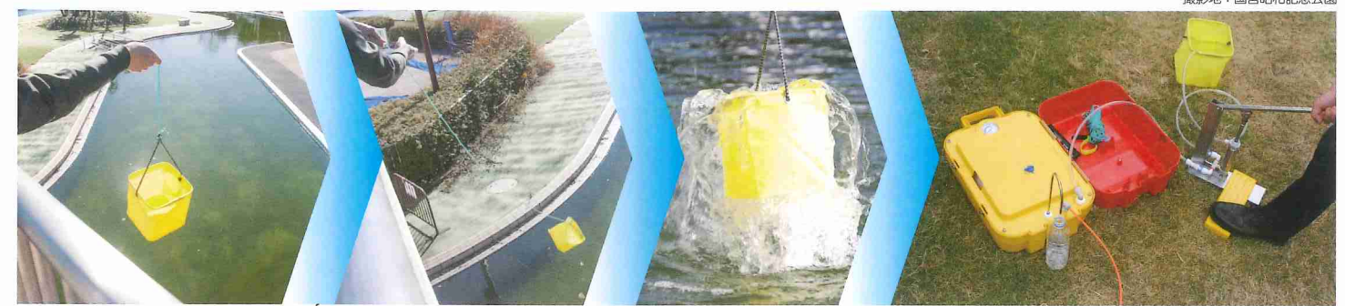
ロープを装着したバケツを用意。 水源へ投入します。 原水を汲み上げます。 汲み上げた原水から飲み水をつくります。
